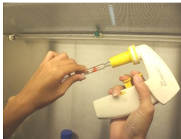
รูปที่ 20 แสดงวิธีการสวมปิเปตเข้ากับ pipette aid
