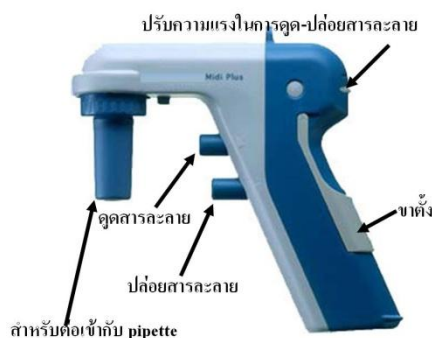
รูปที่ 20 แสดงวิธีการสวมปิเปตเข้ากับ pipette aid
