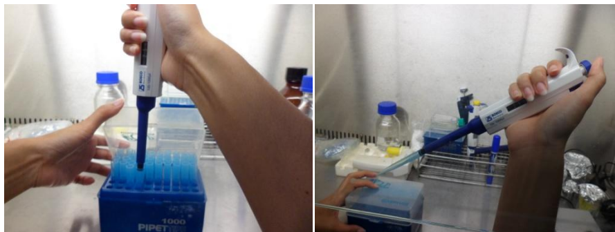
รูปที่ 18 แสดงวิธีการสวม tip เข้ากับไมโครปิเปต
