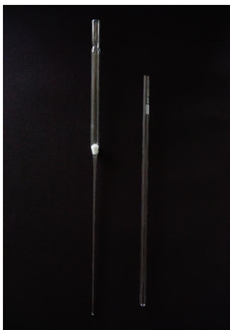
รูปที่ 4.14 รูปแสดงการกรองสารละลายที่ขุ่นหรือมีตะกอนผ่านสำลีลงในหลอด NMR
