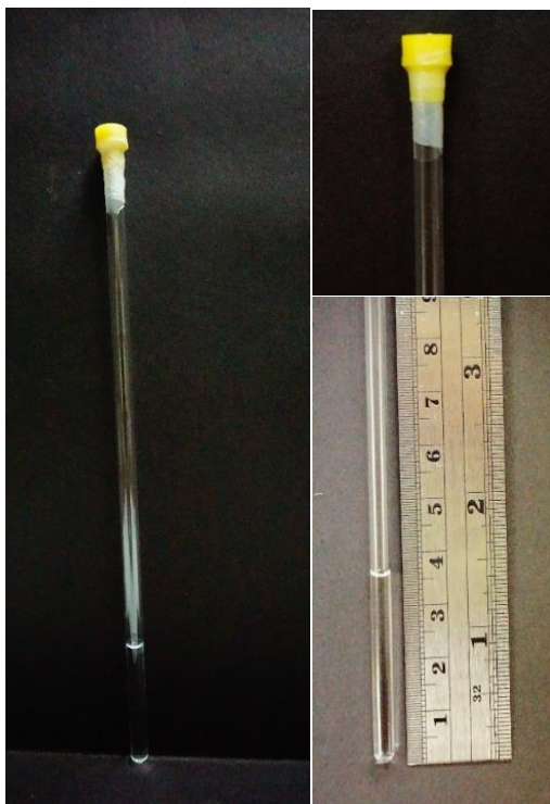
รูปที่ 4.13 รูปแสดงระดับของตัวทำละลายที่เหมาะสมในหลอด NMR
