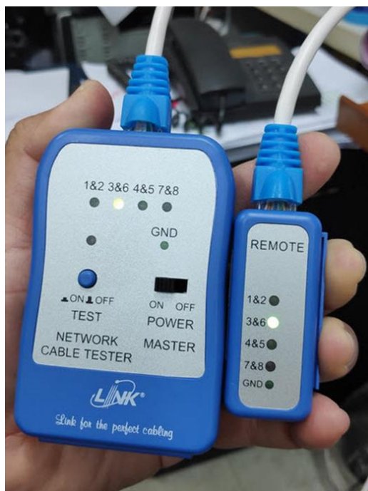
ภาพที่ 4.41 แสดงวิธีใช้งานอุปกรณ์ทดสอบสายแลน
