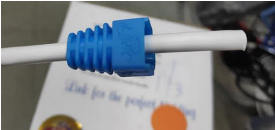
ภาพที่ 4.33 ภาพแสดงการใส่บูทครอบหัว RJ-45
