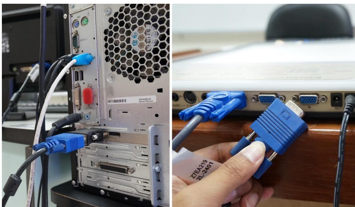
ภาพที่ 4.15 การต่อสายสัญญาณจากเครื่องคอมพิวเตอร์ไปยังเครื่องฉายภาพ 3 มิติ
