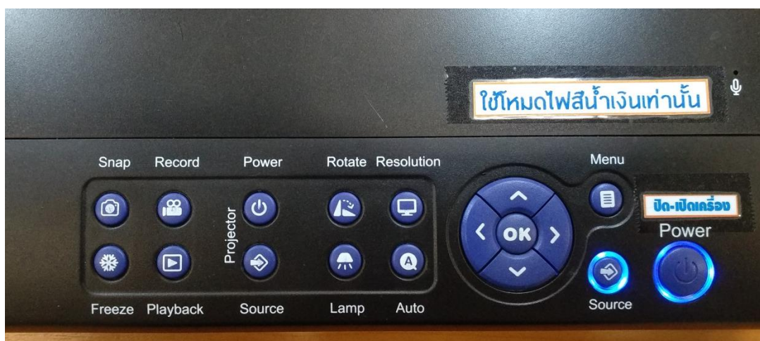
ภาพที่ 4.42 ปุ่มการทำงานต่าง ๆ บนแผงควบคุมของเครื่องฉายภาพ 3 มิติ
