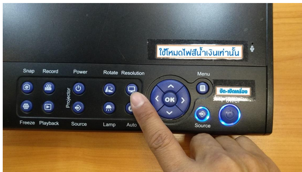
ภาพที่ 4.31 ปุ่ม Resolution สำหรับตั้งค่าความละเอียดบนแผงควบคุมของเครื่องฉายภาพ 3 มิติ
