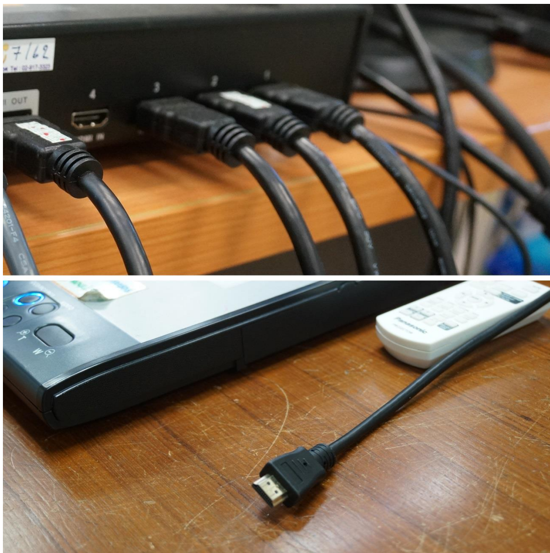
ภาพที่ 4.23 การต่อสายสัญญาณ HDMI ที่เครื่องเลือกสัญญาณภาพ
