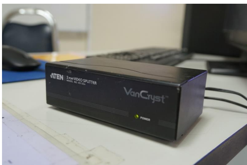
ภาพที่ 3.5 เครื่องแยกสัญญาณภาพแบบ Analog (VGA Splitter)
