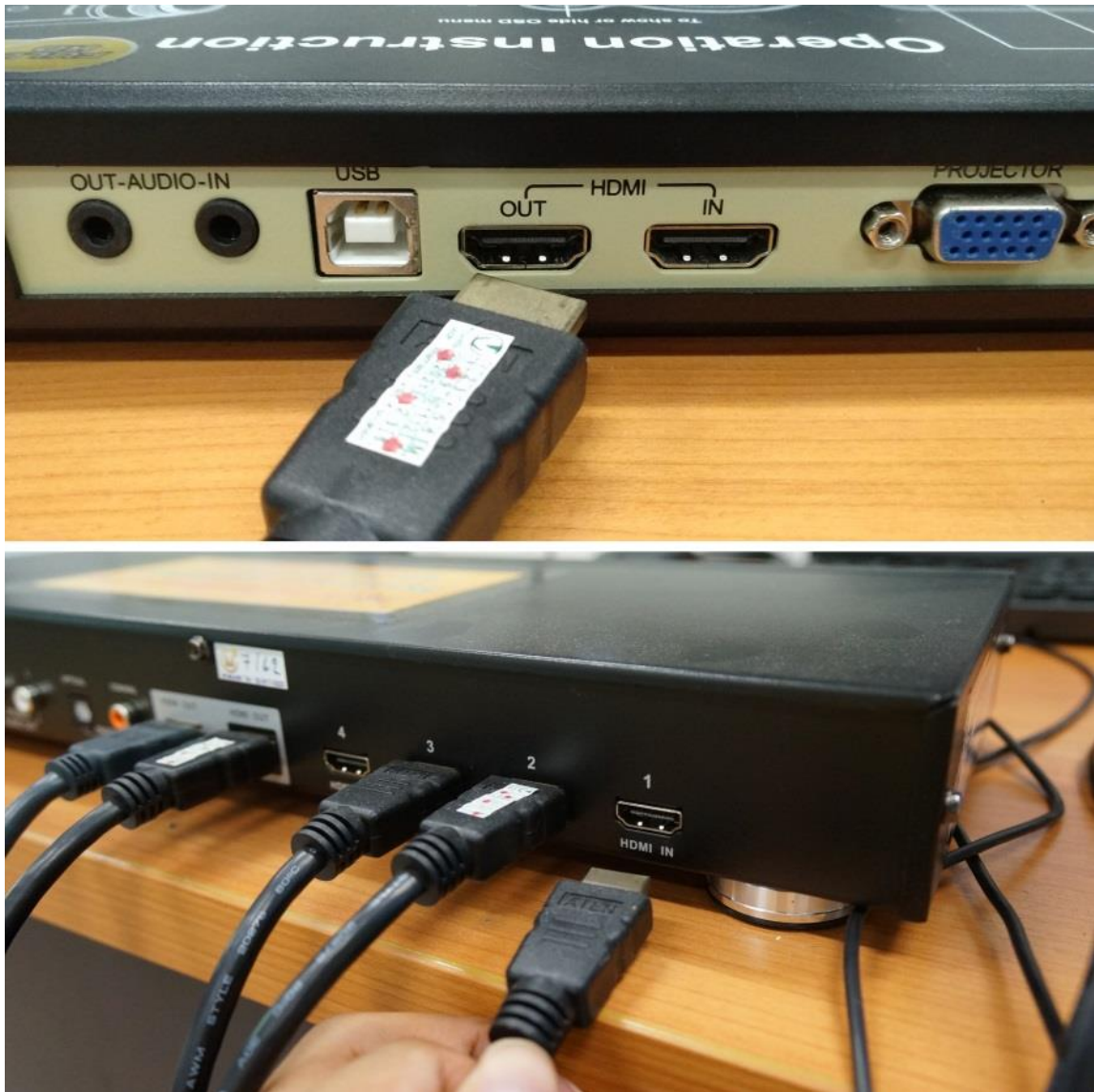
ภาพที่ 4.21 การต่อสายสัญญาณจากเครื่องฉายภาพ 3 มิติไปยังเครื่องเลือกสัญญาณภาพ
