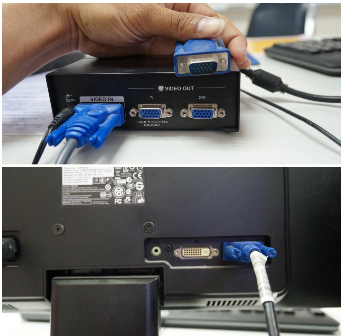
ภาพที่ 4.17 การต่อสายสัญญาณจากเครื่องแยกสัญญาณภาพไปยังจอคอมพิวเตอร์
