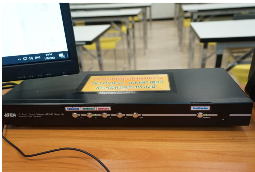
ภาพที่ 3.6 เครื่องเลือกสัญญาณภาพแบบ Digital (HDMI Switcher)
