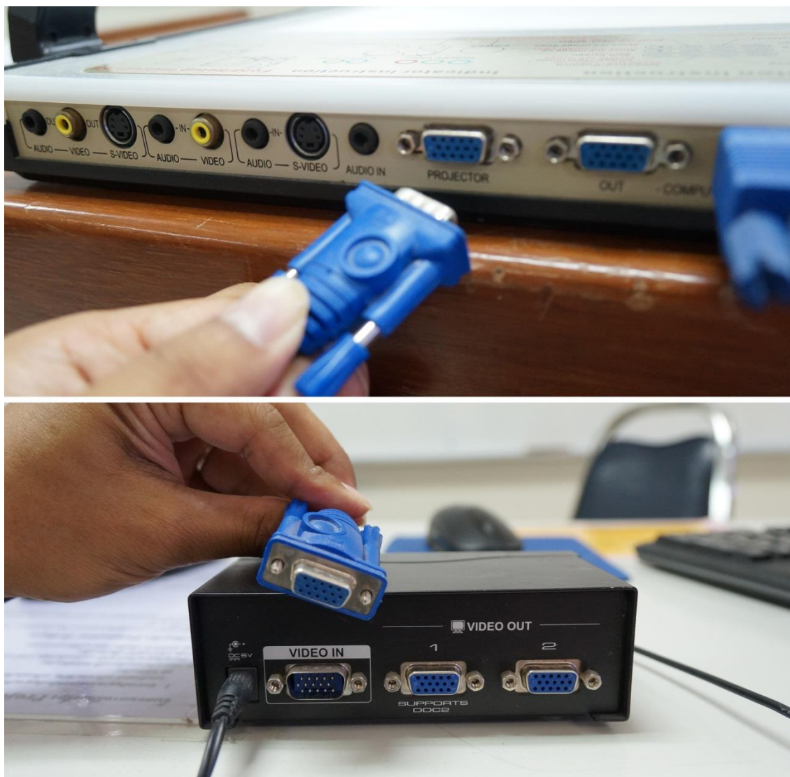
ภาพที่ 4.16 การต่อสายสัญญาณจากเครื่องฉายภาพ 3 มิติไปยังเครื่องแยกสัญญาณภาพ
