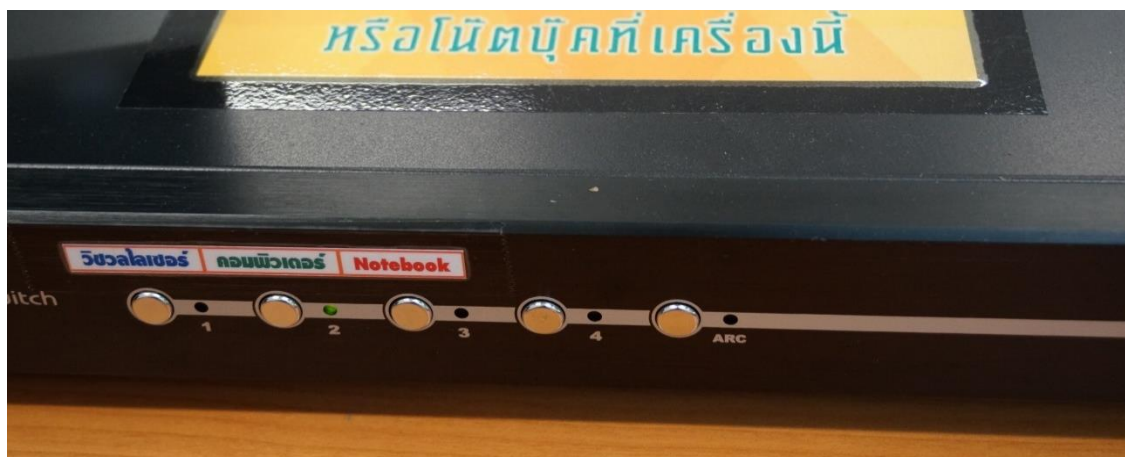
ภาพที่ 4.25 ปุ่มเลือกสัญญาณภาพของเครื่องเลือกสัญญาณภาพ (HDMI Switcher) ชนิดเข้า 4 ออก 2
