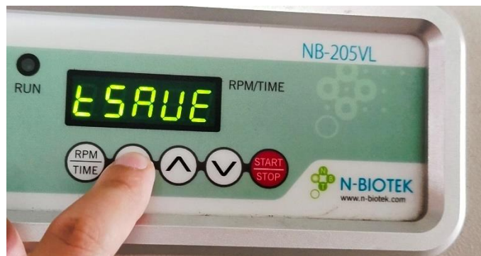
รูปที่ 41 แสดงสัญลักษณ์ยืนยันการตั้งเวลาของเครื่องเขย่าแบบควบคุมอุณหภูมิ (Shaking Incubator) (NB-205VL)
