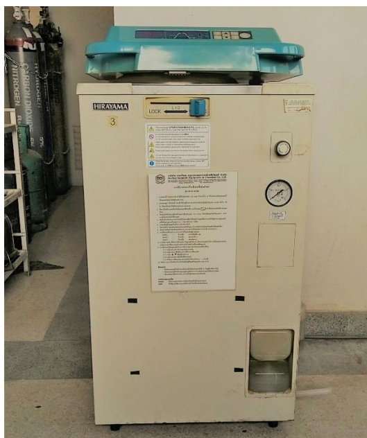
รูปที่ 18 เครื่องนึ่งฆ่าเชื้อ (Autoclave) (Hirayama รุ่น HVE-50)
