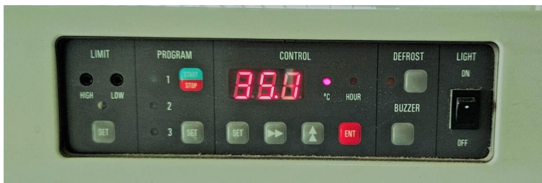
รูปที่ 37 แผงควบคุมอุณหภูมิ และจอแสดงผลของตู้บ่มเชื้อ (Incubator) (SANYO รุ่น MIR-253)
