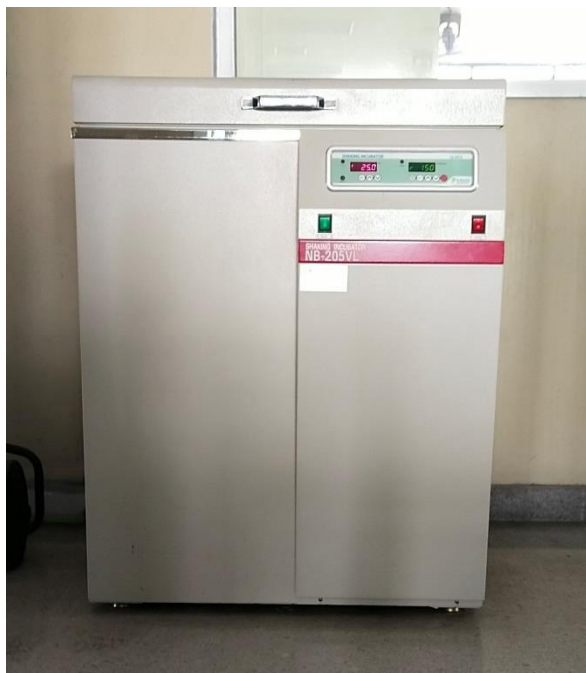
รูปที่ 38 เครื่องเขย่าแบบควบคุมอุณหภูมิ (Shaking Incubator) (NB-205VL)
