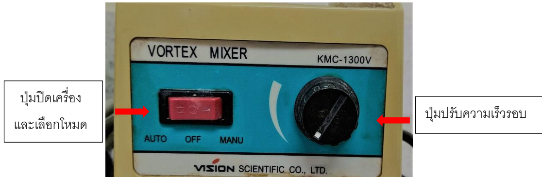
รูปที่ 11 แสดงปุ่มปิดเครื่อง ปุ่มเลือกโหมดการใช้ และปุ่มปรับความเร็วรอบ ของเครื่องผสมสาร (Vortex mixer) (Vision รุ่น KMC-1300V)
