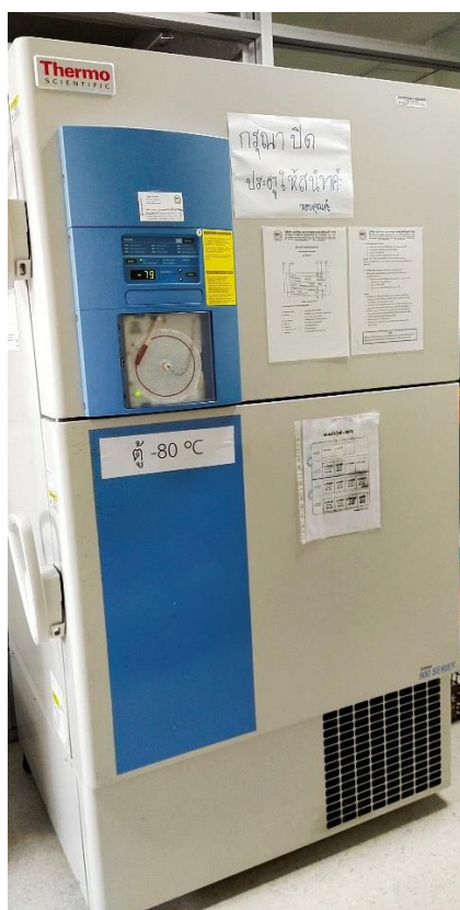
รูปที่ 54 ตู้แช่แข็ง (Deep freeze) (ThermoFisher Scientific รุ่น 900)
