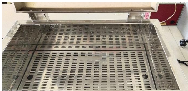
รูปที่ 13 แสดงระดับน้ำภายในอ่างน้ำควบคุมอุณหภูมิ (Water bath) (Julabo รุ่น TW20)
