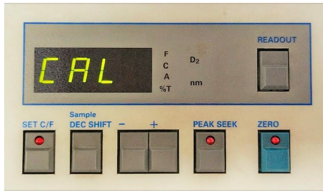
รูปที่ 49 แสดงข้อความ CAL ที่หน้าจอแสดงผลของเครื่องวัดค่าการดูดกลืนแสง (Spectrophotometer) (Cecil รุ่น 1011)
