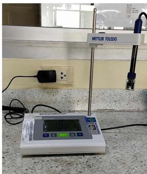
รูปที่ 5 เครื่องวัดค่าความเป็นกรด-ด่าง (pH meter) (Mettler Toledo)
