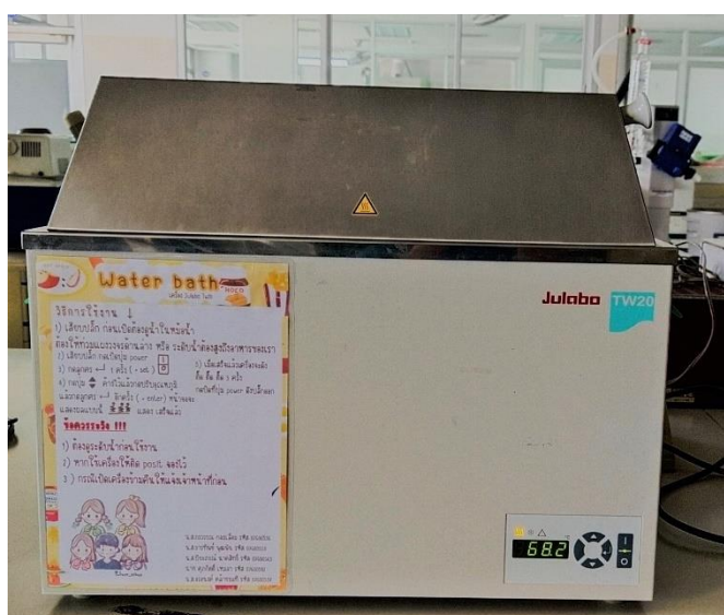
รูปที่ 12 อ่างน้ำควบคุมอุณหภูมิ (Water bath) (Julabo รุ่น TW20)
