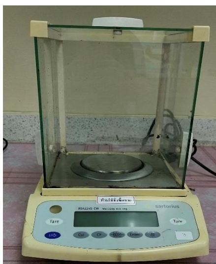
รูปที่ 3 เครื่องชั่ง 4 ตำแหน่ง (Precision balance) (Sartorius รุ่น BSA224S-CW)
