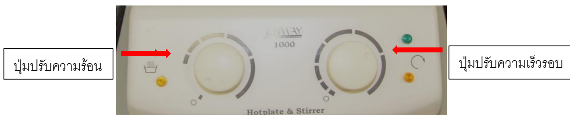
รูปที่ 9 แสดงปุ่มปรับความร้อน และปุ่มปรับความเร็วรอบของเครื่องกวนสารพร้อมให้ความร้อน (Hotplate stirrer) (Jenway รุ่น 1000) ที่มา www. Scientificservices.eu
