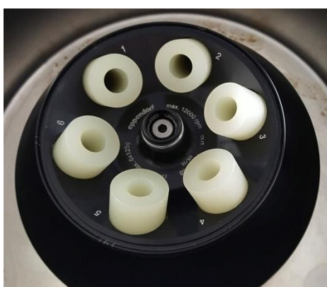
รูปที่ 44 แสดง adapter ขนาด 15 มิลลิลิตร (ซ้าย) และ 50 มิลลิลิตร (ขวา) ของเครื่องปั่นเหวี่ยง (Centrifuge) (Eppendorf รุ่น 5804R)
