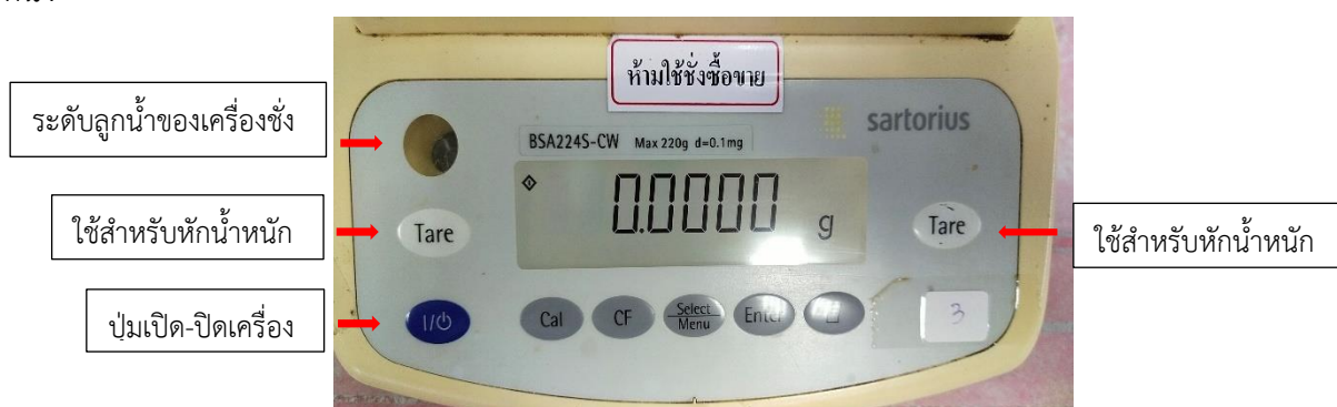
รูปที่ 4 จอแสดงผล และแผงควบคุมของเครื่องชั่ง 4 ตำแหน่ง (Precision balance) (Sartorius รุ่น BSA224S-CW)
