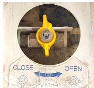
รูปที่ 20 แสดงวาล์วถ่ายน้ำออกจากตัวเครื่องของเครื่องนึ่งฆ่าเชื้อ (Autoclave) (Hirayama รุ่น HVE-50)
