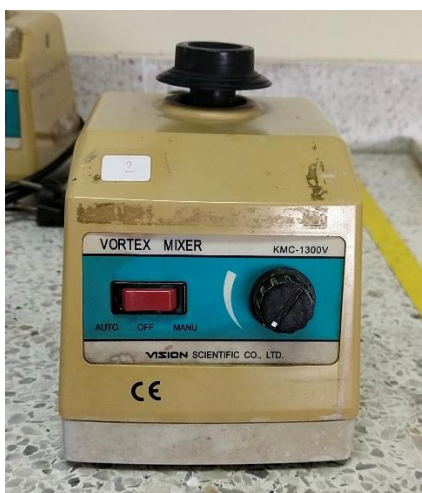
รูปที่ 10 เครื่องผสมสาร (Vortex mixer) (Vision รุ่น KMC-1300V)
