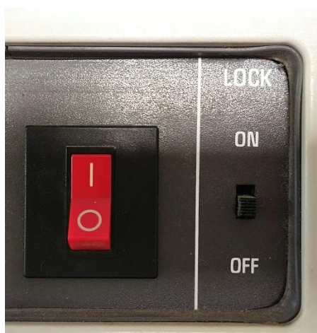
รูปที่ 36 ปุ่มเปิด-ปิด และปุ่มล๊อคอุณหภูมิของตู้บ่มเชื้อ (Incubator) (SANYO รุ่น MIR-253)
