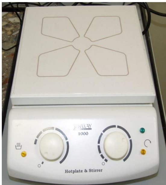
รูปที่ 8 เครื่องกวนสารพร้อมให้ความร้อน (Hotplate stirrer) (Jenway รุ่น 1000) ที่มา www. Scientificservices.eu
