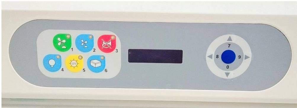
รูปที่ 30 แสดงปุ่มกด และแผงควบคุมของตู้ปลอดเชื้อ (Biological Safety Cabinet, BSC) (ScanLaf รุ่น Mars 1200)
