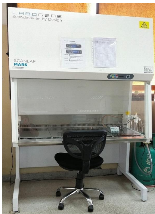
รูปที่ 29 ตู้ปลอดเชื้อ (Biological Safety Cabinet, BSC) (ScanLaf รุ่น Mars 1200)
