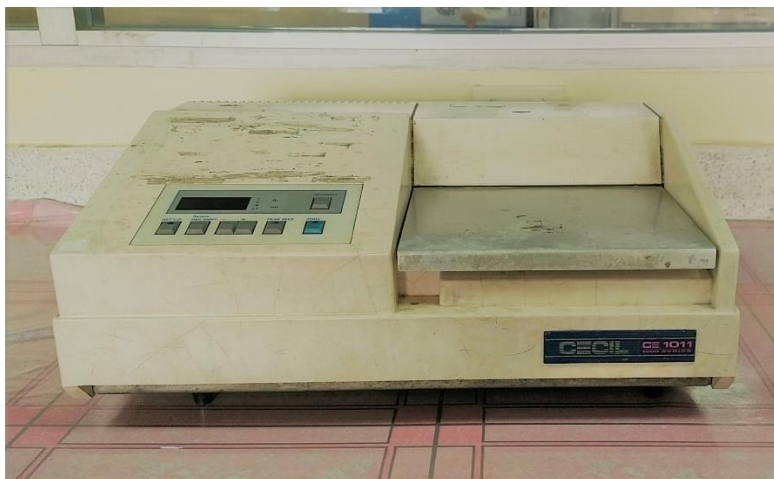
รูปที่ 45 เครื่องวัดค่าการดูดกลืนแสง (Spectrophotometer) (Cecil รุ่น 1011)
