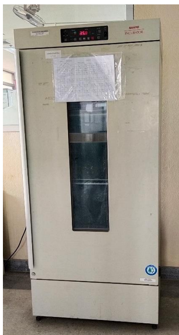
รูปที่ 35 ตู้บ่มเชื้อ (Incubator) (SANYO รุ่น MIR-253)
