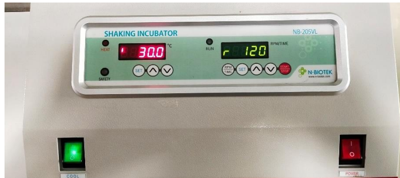
รูปที่ 39 ปุ่มกด และแผงควบคุมเครื่องเขย่าแบบควบคุมอุณหภูมิ (Shaking Incubator) (NB-205VL)
