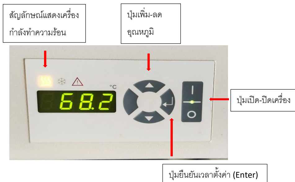
รูปที่ 14 แสดงปุ่มควบคุมเครื่อง และหน้าที่ในการทำงานของอ่างน้ำควบคุมอุณหภูมิ (Water bath) (Julabo รุ่น TW20)
