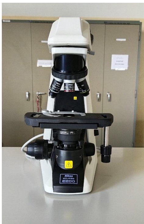
รูปที่ 51 กล้องจุลทรรศน์ (Light microscope) (Nikon รุ่น E200)
