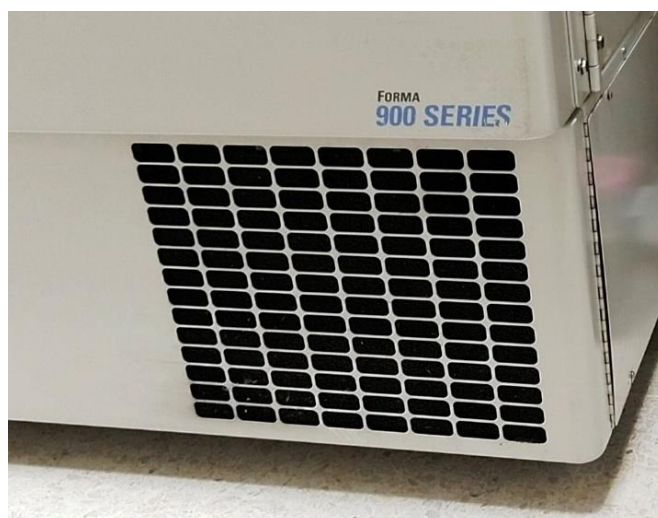
รูปที่ 57 แสดงแผ่นกรองฝุ่นของตู้แช่แข็ง (Deep freeze) (ThermoFisher Scientific รุ่น 900)
